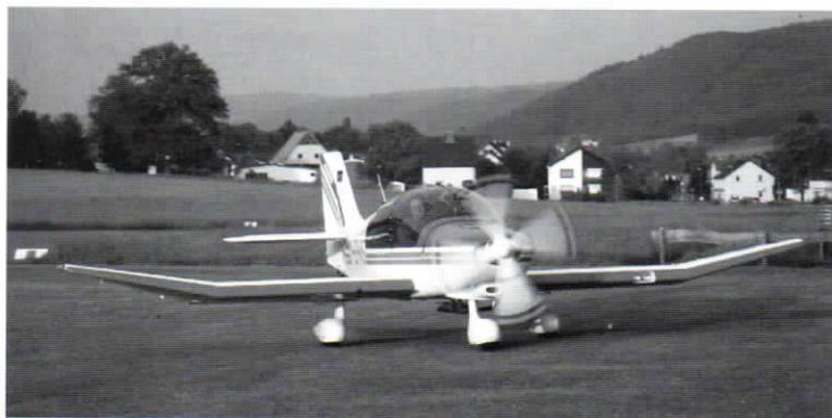
leichte und leistungsstarke Flugzeug eingesetzt. Charakteristisch für eine DR 400 sind die Knickflügel.
