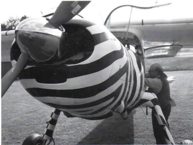
schwierig, aber nach nur acht Monaten Bauzeit entstand dieses einzigartige Flugzeug, das alle Voraussetzungen erfüllte. Es fliegt mit einer minimalen Geschwindigkeit von 50 km/h sowie einer maximalen von 260 km/h. Zum Start wird eine Strecke von nur 380 Metern benötigt, zur Landung sogar nur 290 Meter.
